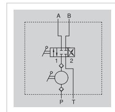
12/25/45 cm<sup>3</sup> el pompaları tank üstü monte edilebilir. Boyalı döküm göße, kromlu mil, 4 yolu 3 yön bölücü L= 600 mm çalışma kolu. İsteğe göre kol için plastik koruma ve emniyet valfi.
